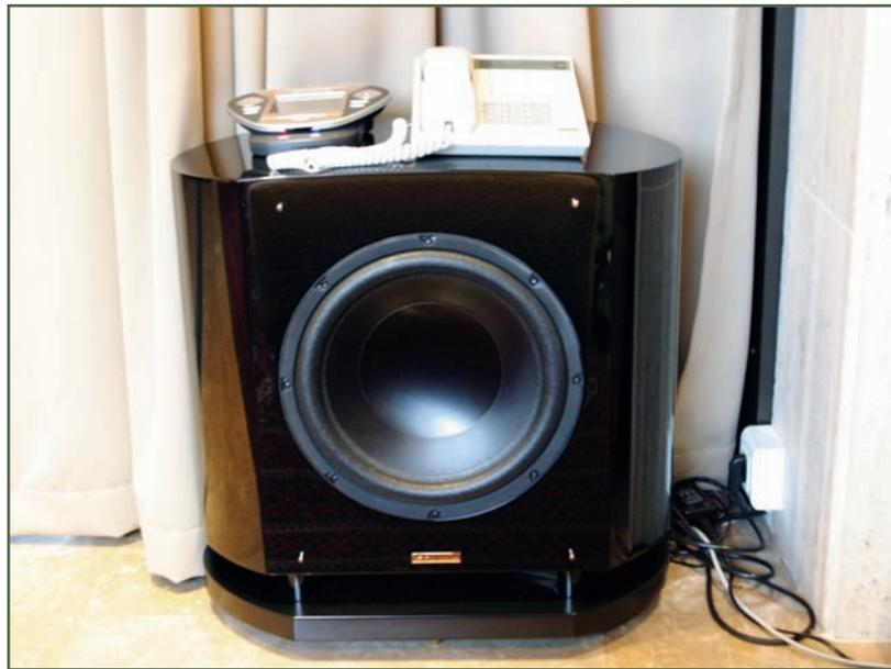
*Les deux caissons de grave Cabasse Largo sont de faible profondeur. Installés de chaque côté de la pièce, ils se font discrets et permettent d'obtenir une excellente assise dans les basses.*
