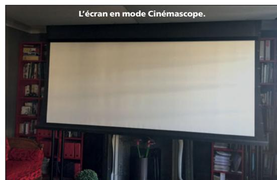
noir mat pour limiter toute réflexion parasite à proximité de l'image. Pour assurer une parfaite planéité de la toile dans le temps, celle-ci est tensionnée. Autre particularité, elle est acoustiquement transparente et peut ainsi descendre devant les enceintes frontales sans craindre une altération du message sonore. Cerise sur le gâteau, cet écran intègre un système de masque pour adapter précisément la
